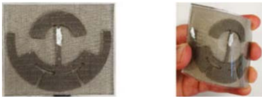
(a)正视图 (b)弯曲图 图 8 超宽带可穿戴天线 [65]
