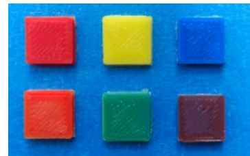
图9 纯色、混色小方块测试打印结果
