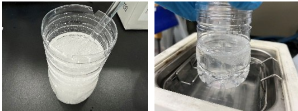
图16 超声波消除气泡效果
