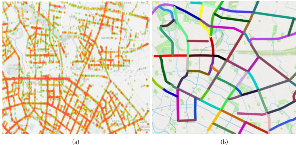
图2 原始轨迹分布热图与成都市区路网的路段划分示意图
