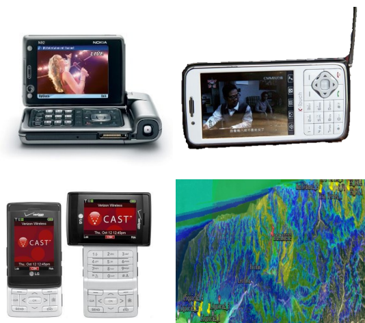
图1 支持移动多媒体广播的2G/3G手机终端 (左上:DVB-H(Nokia N92);右上:CMMB(天语 V958);左下:MediaFLO(LG VX9400);右下:T-DMB(LG Shine DMB定制版))
