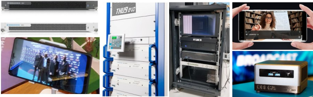
图8 5G广播设备(左一上:R&S BSCC 1.0/2.0 5G广播网关,左一下:高通工程手机;左二:R&S THU9evo 5G广播发射机;右二:中国传媒大学试验发射机;右一上:华为Mate40 Pro NR MBS手机(内部固件);右一下:OBECA SDR广播发射机)
