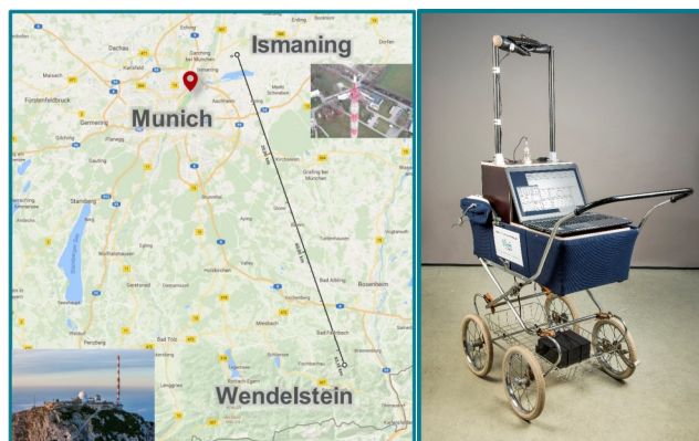
图10 5G Today项目部署情况(左:发射点位置;右:接收设备实物图)
