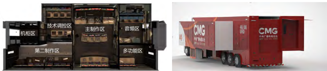
图6 新建A类4K/8K超高清转播车车体及车内布局图
