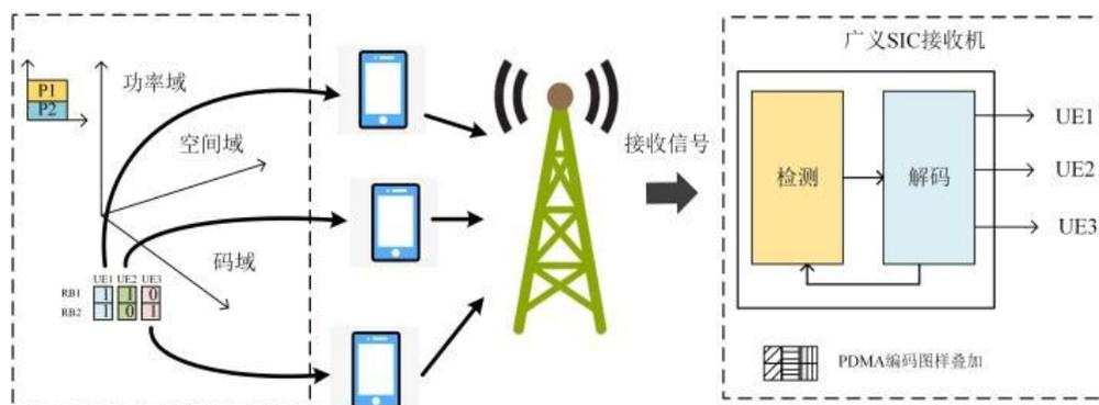
图1 PDMA上行传输框架
